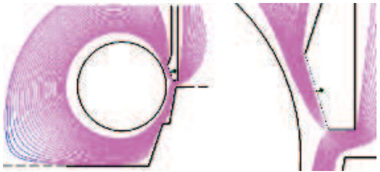
Рис. 3. Линии тока при вращении цилиндра с линейной скоростью v_{вр} = 0,5 м/с и v_0 = 0,5 м/с
