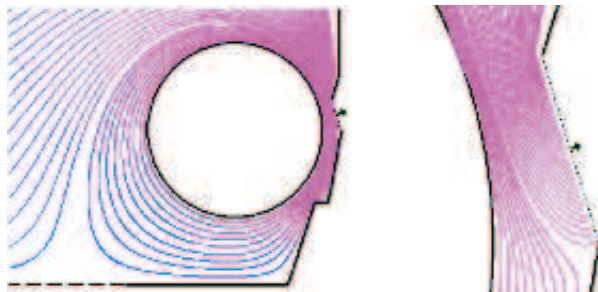
Рис. 11. Линии тока при вращении цилиндра с линейной скоростью v_{вр} = 0,5 м/с и v_0 = 1 м/с
